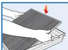
4. Закрепите корпус сначала внизу прибора, а затем сверху.
