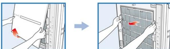
2. Распакуйте фильтры (кроме Предварительного фильтра) и вставьте их в корпус в следующем порядке: Предварительный – Средний – HEPA – Противоаллергенный Дезодорирующий.
